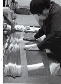
上/機械化が進む中、手作業による検査工程も不可欠 右/ステンレスの板材。造管、肉決、洗浄、焼鈍、伸管など多数の工程を経てパイプを加工する
